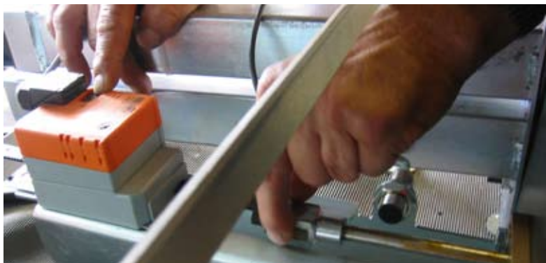
Bild nr. 3: Kontrollera att rosterrengöringslänkaget är lätttrörligt.
