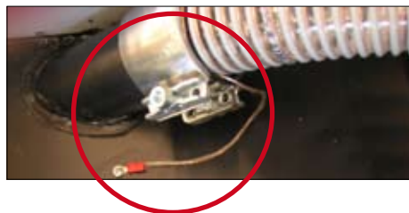
Bild nr. 21: Monterad klämring med jordning (genom koppartrådarna i matarslangen).
